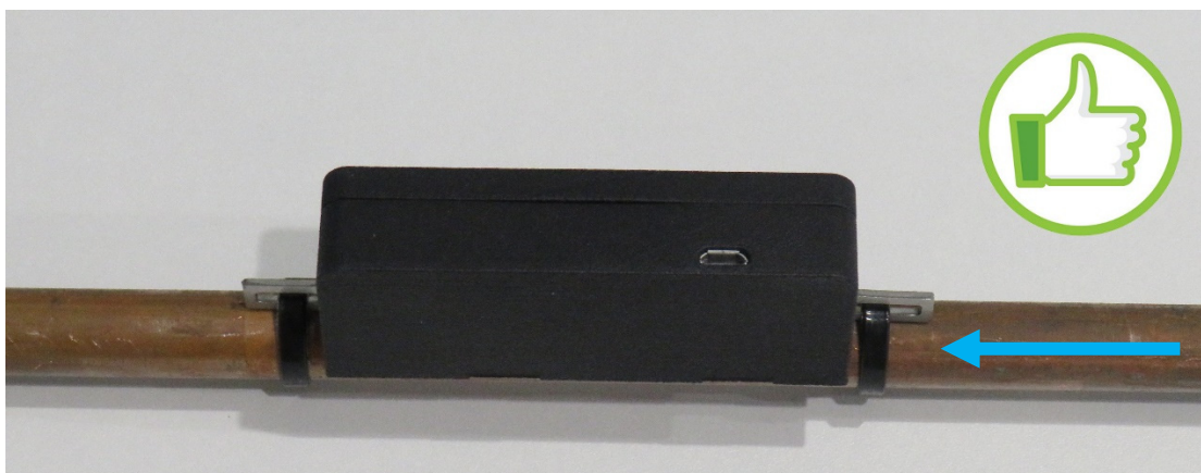
Afbeelding 2: Smart Fluid Monitor correct bevestigd op een (koper) leiding.
